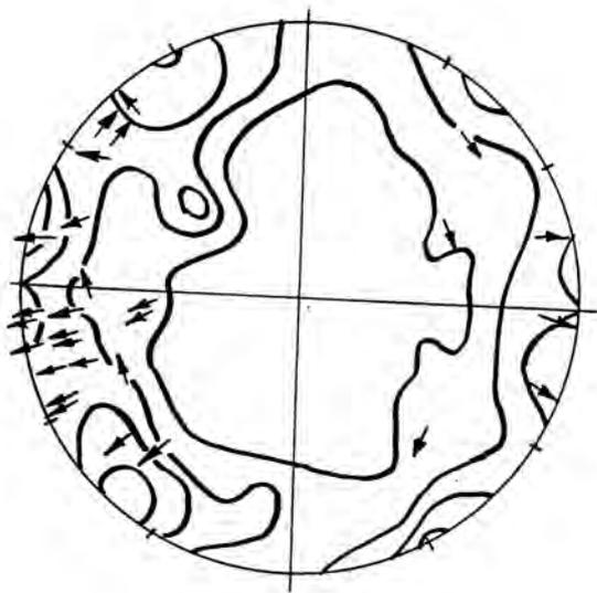
Рис. 6. Стереограмма изолиний концентрации полюсов трещин и векторов подвижек в районе сейсмодислокации (Гора Южная Демерджи).
